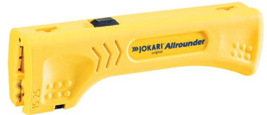
Zum Entmanteln aller gängigen Rundkabel, inkl. Kabel für Gebäudeinstallation, Feuchtraumkabel, Industriekabel, z. B. Energie-, Control-, Telefon-, Solar-, Sensor-, Coax-, Cat-Kabel). Keine Einstellung der Schnitttiefe erforderlich. 2 Präzisions-Abisolierklingen für Einzeladern mit Längenanschlag. Längenanschlag kann entfernt und sowohl für Rechts- als auch Linkshänder positioniert werden. Befestigungsmöglichkeit für Handschlaufe.
