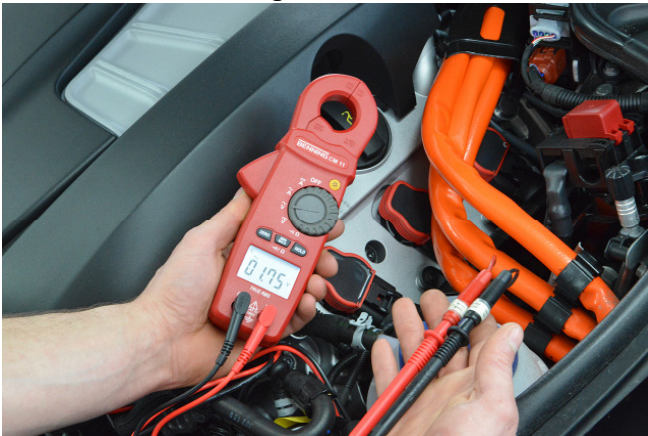
Spannungsmessung an einer Füllstandssensoren
